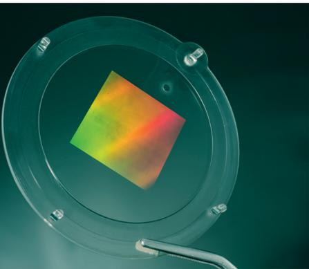
Spritzgegossene Nanostrukturen (hier 200 nm Säulen auf 44 x 44 mm) dank variothermer Werkzeugtemperierung.
