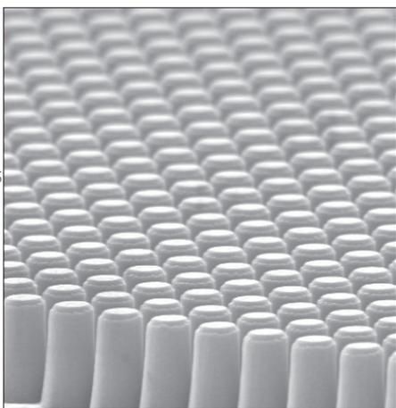
Perfekte Strukturabformung gewährleistet Funktion (Säulenhöhe 2.5 Mikrometer).
